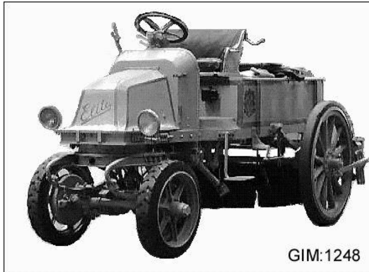
Elektrisk sopmaskin från Göteborgs renhållningsverk, tillverkad 1921.
